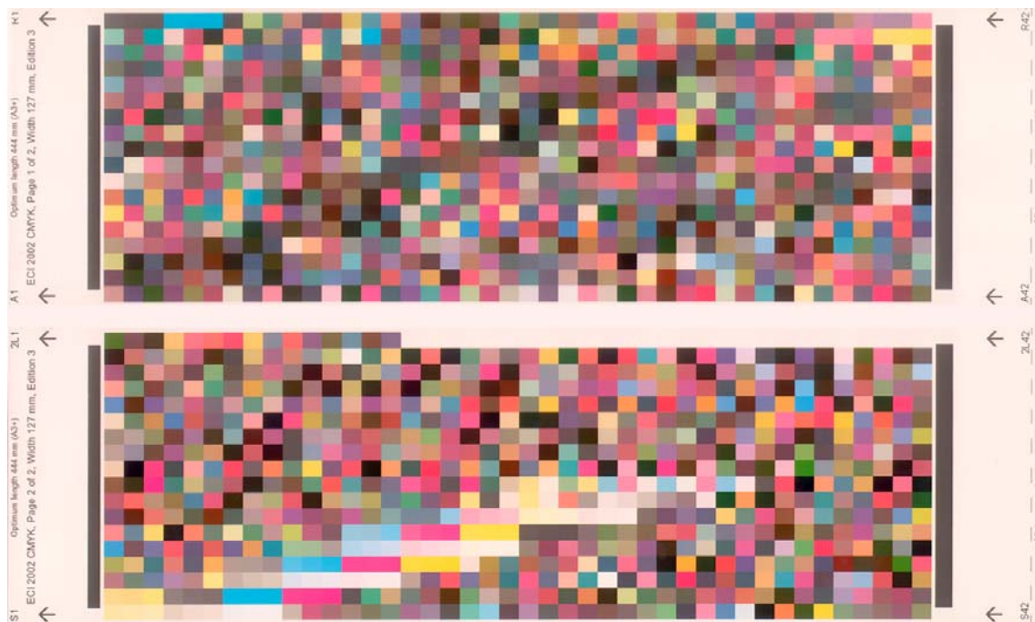
2ª fase de obtención de pruebas contractuales: Obtención del test ECI 2002 con el perfil ISONEWSPRINT26 V4. La comparación de los valores colorimétricos obtenidos con los valores del perfil de referencia permitirá determinar la exactitud de la simulación.
