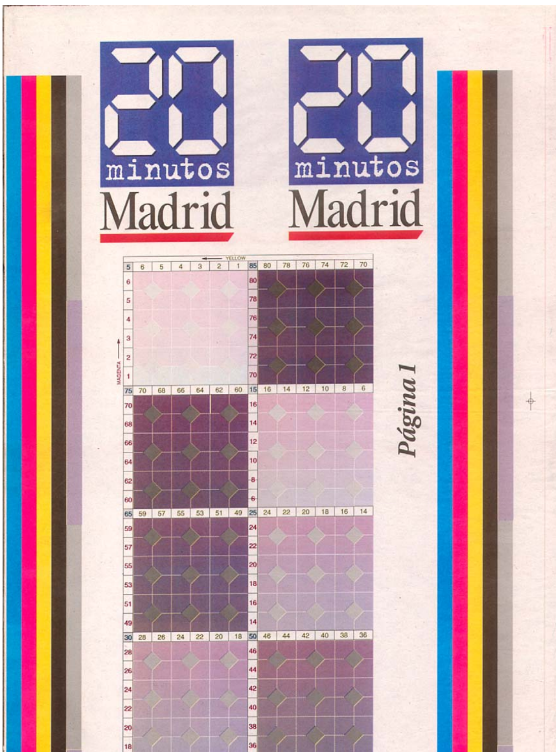
Página "1" del test. Parches de grises para determinar el mejor balance y barras de cian, magenta amarillo, negro y gris (negro y tricromático) en el sentido de impresión.
