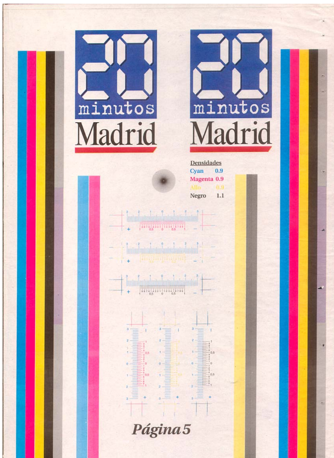
Página "5" del test. Colores sólidos, y tramados. Elementos de control de registro.
