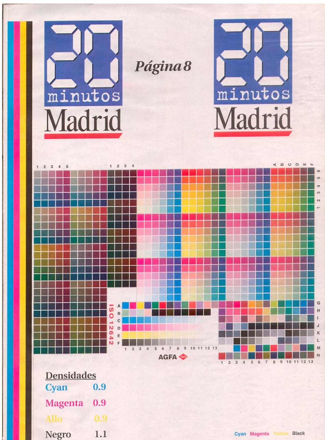
Página "8" del test. Colores sólidos. Test IT8 7/3 para la generación del perfil de impresión.
